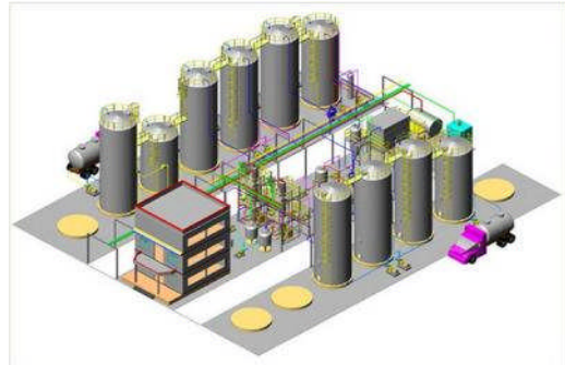
Einfaldar skýringamyndir sem sýna uppbyggingu bíodísilbúnaðar
