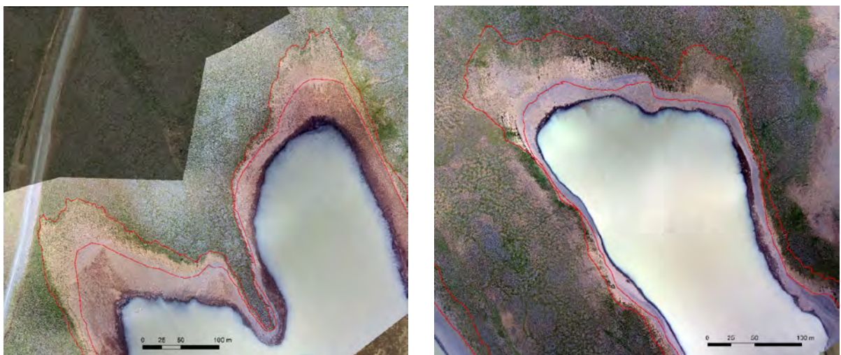
21. mynd. Yfirlitsmyndir af botni Botnlangavíkur (t.v.) og Lambavíkur (t.h), teknar úr u.þ.b. 100 m hæð með dróna 23. ágúst 2016. Rauðar línur sýna útlínur sanddreifar ofan fjörumarka eins og þær voru kortlagðar með GPS-tækjum á jörðu niðri (sbr. 21. mynd) Á þessum tíma var lónborð um 1 m neðan yfirfallshæðar. Sjá nánar í 5. viðauka.
