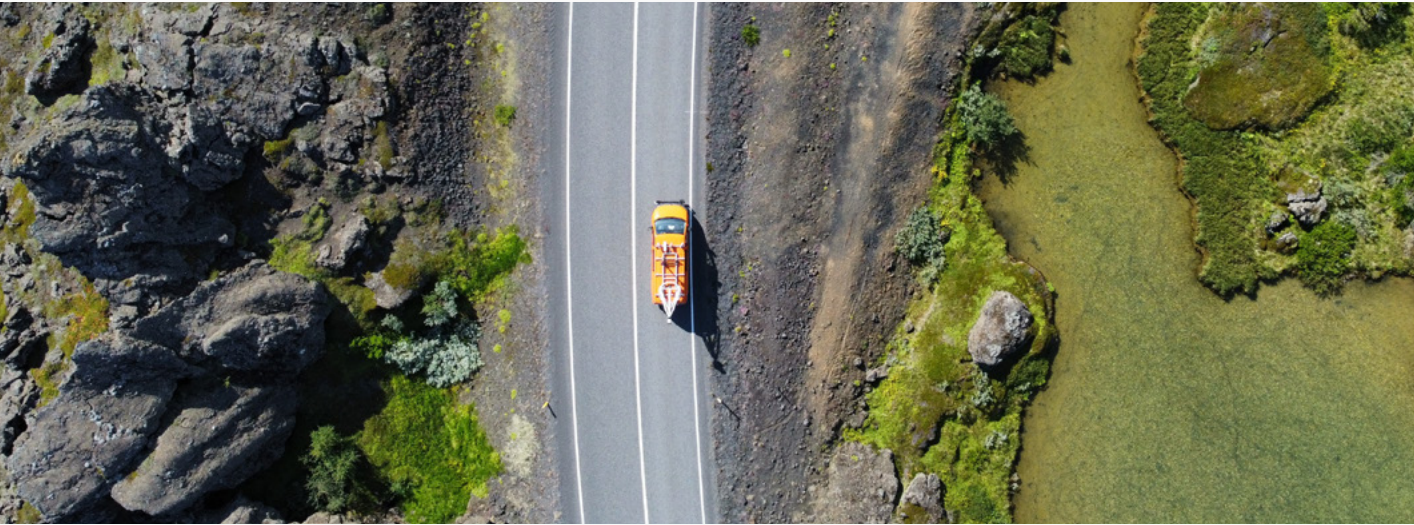
↑ Veggreinir Vegagerðarinnar að störfum við Mývatn sumarið 2023. Veggreinir er sérútbúinn mælibíll sem getur mælt yfirborð vega og nánasta umhverfi.
