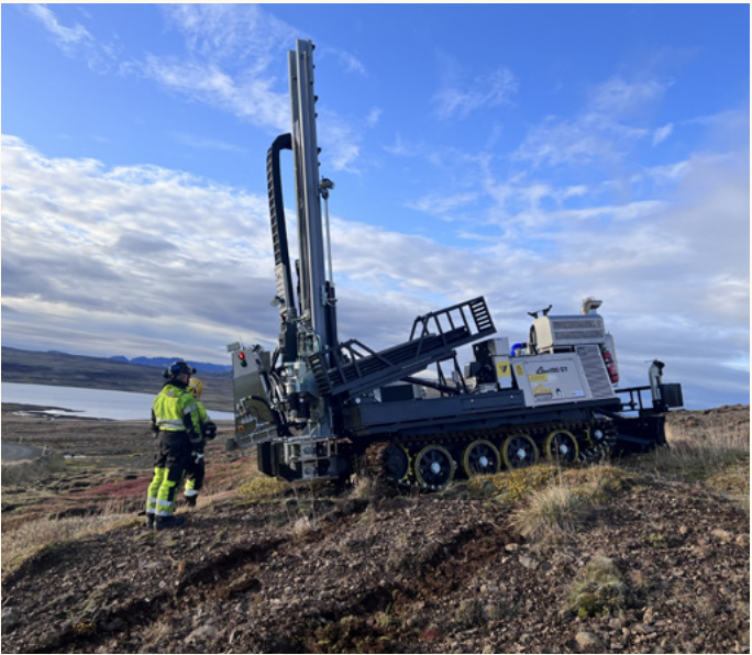
↑ Vegagerðin festi kaup á nýjum jarðtækniþor sem verður notaður til ýmissa rannsókna sem gagnast við hönnun vegja.
