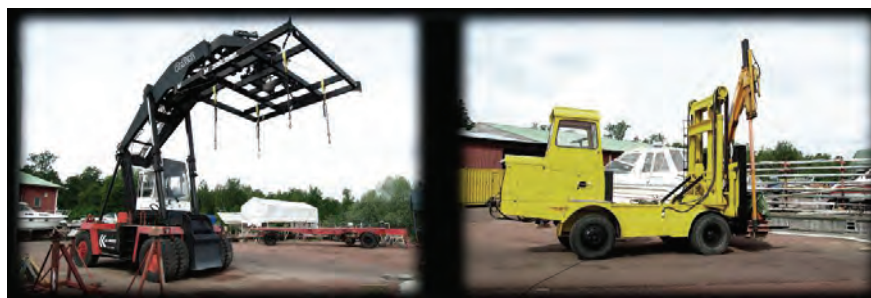
Mynd 25. Lyftari til að lyfta bátum í uppsátur og masturslyftari á slippstöð Á3.
