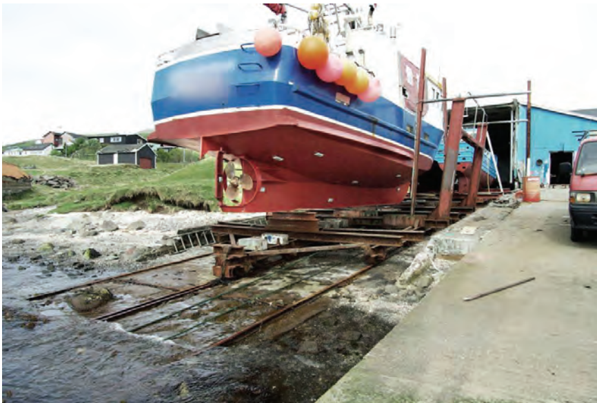
Mynd 34. Slippstöð F1: Grind á teinum á steiptu plani.
