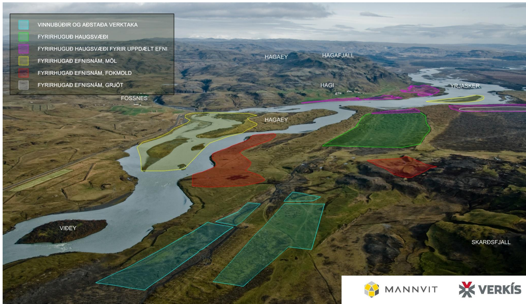
MYND 2.11 Horft í norður yfir framkvæmdasvæðið. Myndin sýnir efnistökusvæði, haugsetningu, vinnubúðir og aðstöðu verktaka.
