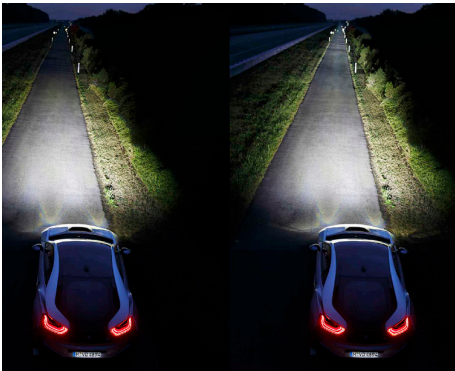
BMW var fyrstur bílaframleiðenda til að bjóða fjöldaframleiddan bíl með leiserljósum sem hafa tvöfalt drægi LED-ljósa.
