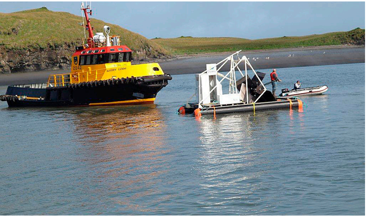
Flekkinn í 1 m/sek straumi í Mikleyjarál með hverfil í efri stöðu. Ljósmynd/Jóhann Eyvindsson.
