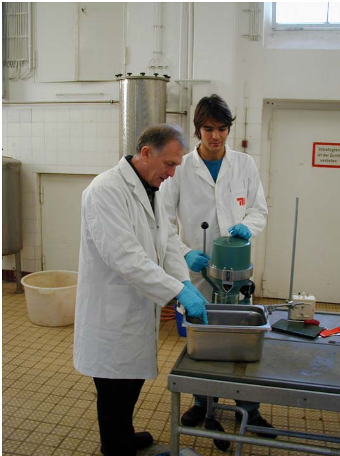
Mynd 3. Unnið við pressun á fiskmauki eftir hitun með Hafico-pressu.
