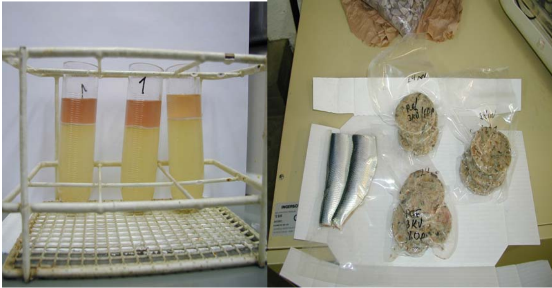
Mynd 4. a) Pressuvökvi eftir skilvindun. Lýsið er brúnleitt og efst í glasinu, b) pressukökur úr síld ásamt vakúmpakkaðri síld.
