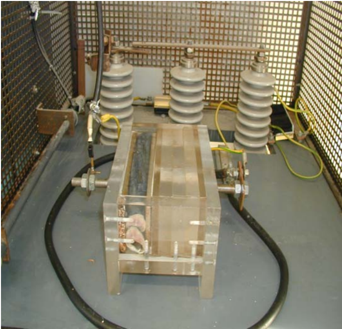
Mynd 2. Síld milli tveggja rafskauta
