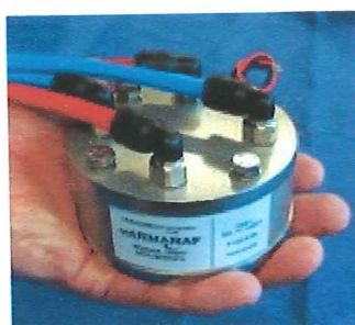
Mynd 4. Varmaskiptir úr áli. Rafafli varmarafala í þessu tilviki er aðeins nokkur wött, en unnt er að auka það með fleiri lögum.
