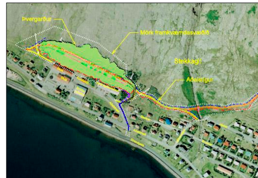
Snjóflóðavarnir Patreksfirði, þvergarður við Klif.
