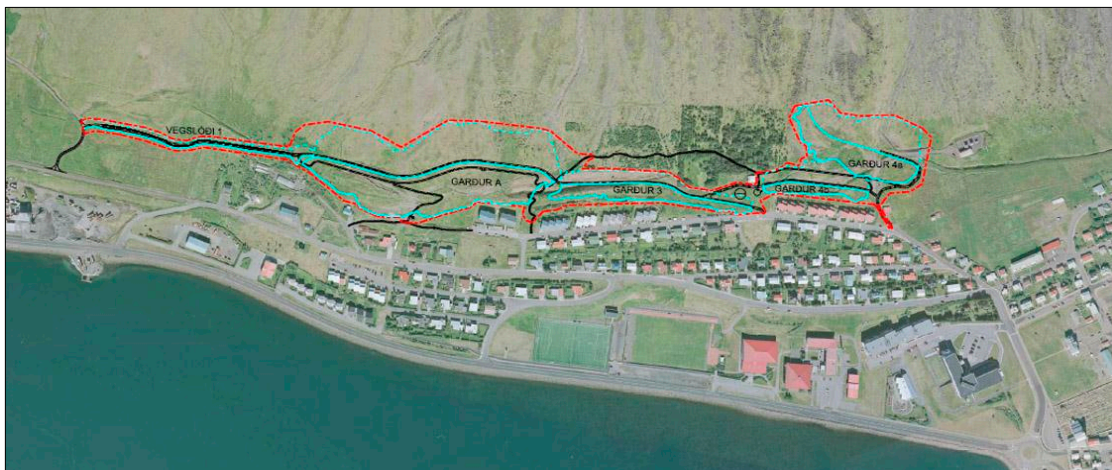
Ofanflóðavarnir á Ísafirði, í Gleiðarhjalla, yfirlitsteikning.
