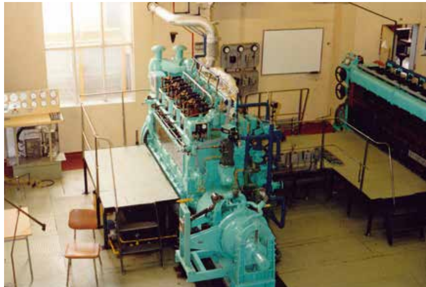
Vélasalur Tækniskólans. Fjögurra strokka díselvél með álagsbremmsu
