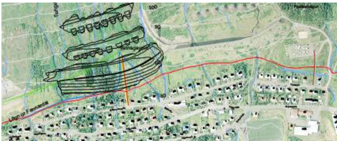
Mynd 23 Hluti af mynd Verkís sem sýnir lagnir neðan fyrirhugaðra garða. Svartar línur sýna fyrirkomulag varna, rauðar rafmagn, gular símalagnir, bláar vatnslagnir og græna punktalínar sýnir aflagða vatnslögn. Mynd tekin úr skýrslu Verkís, teikning nr. U60.01.017 (6), sjá Viðauka 1 og 5.
