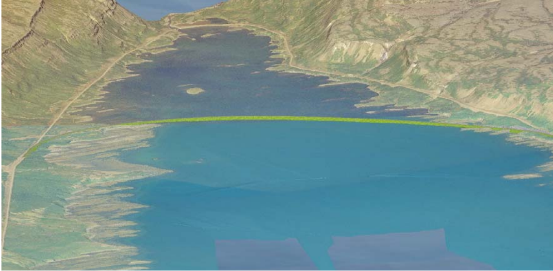
Þrívíddarmynd 22. Þverun Kjálkafjarðar, séð úr lofti inn fjörðinn (myndin sýnir allt svæði VIII). Grænt= fylling, grátt= skering. Myndvinnsla: Halldór Sv. Hauksson.
