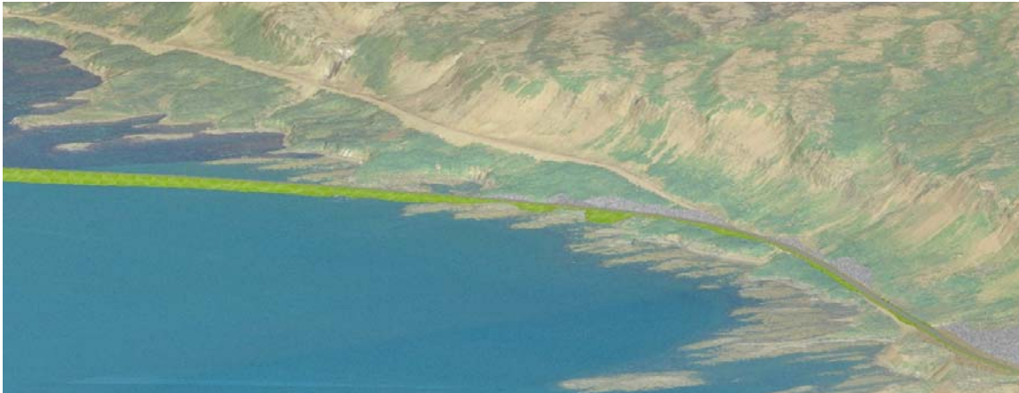
Þrívíddarmynd 24. Austari hluti þverunnar um Kjálkafjörð. Grænt= fylling, grátt= skering. Myndvinnsla: Halldór Sv. Hauksson.
