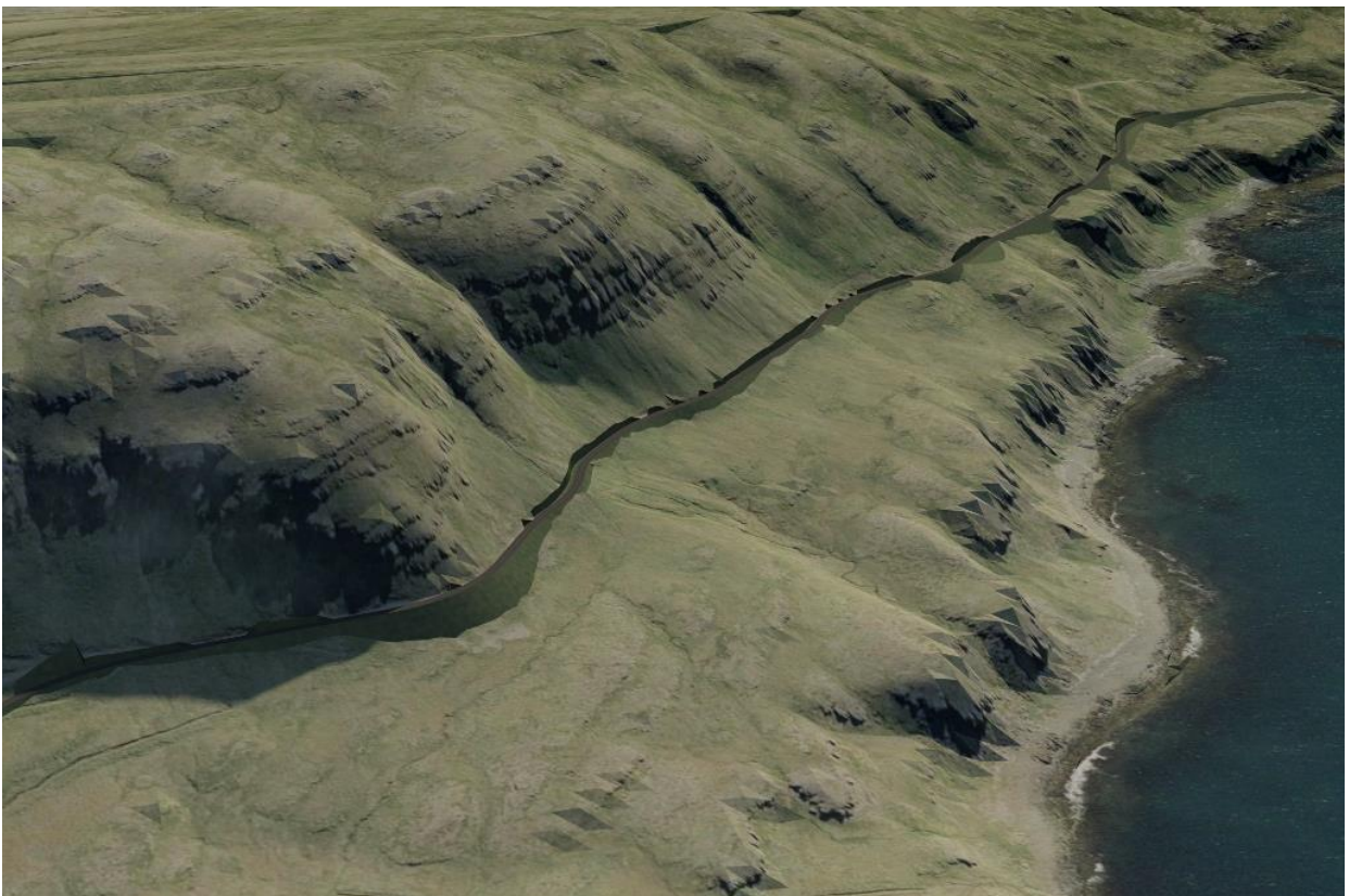
Mynd 7.61 Sama sjónarhorn og að ofan. Vegurinn mun að mestu liggja í eða við núverandi vegstæði fyrir utan tvo kafla og ræsi verður sett yfir Sýrá, efst í hægri horni myndarinnar. Mynd Verkís / Loftmyndagrunnur Loftmyndir ehf.
