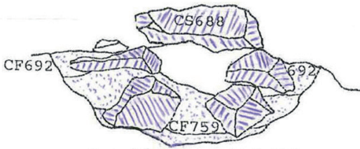
9. mynd. Sniðteikning af stokki ásamt fyllingarlagum. Hólslögn. Merkingar með penna eru höfundar, með leyfi eftir umtali: Punktar: Leir; Skástrik: Skarphyrnt grjót. Mynd: Skýrslur Þjóðminjasafns 2003/3. G.S.
