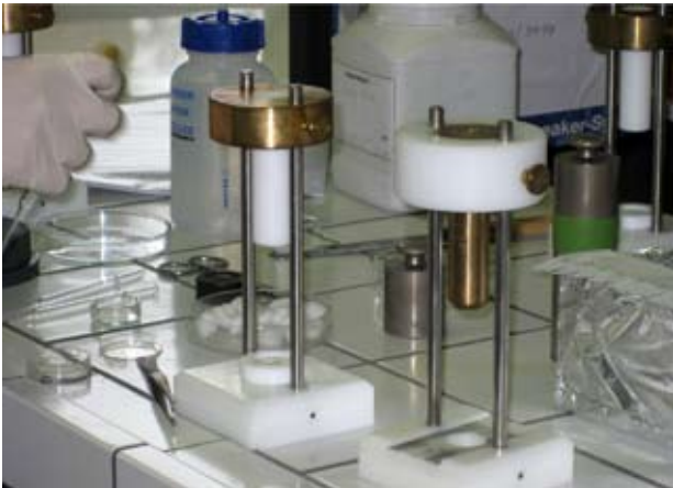
Saarbrücken penetration módelið.
