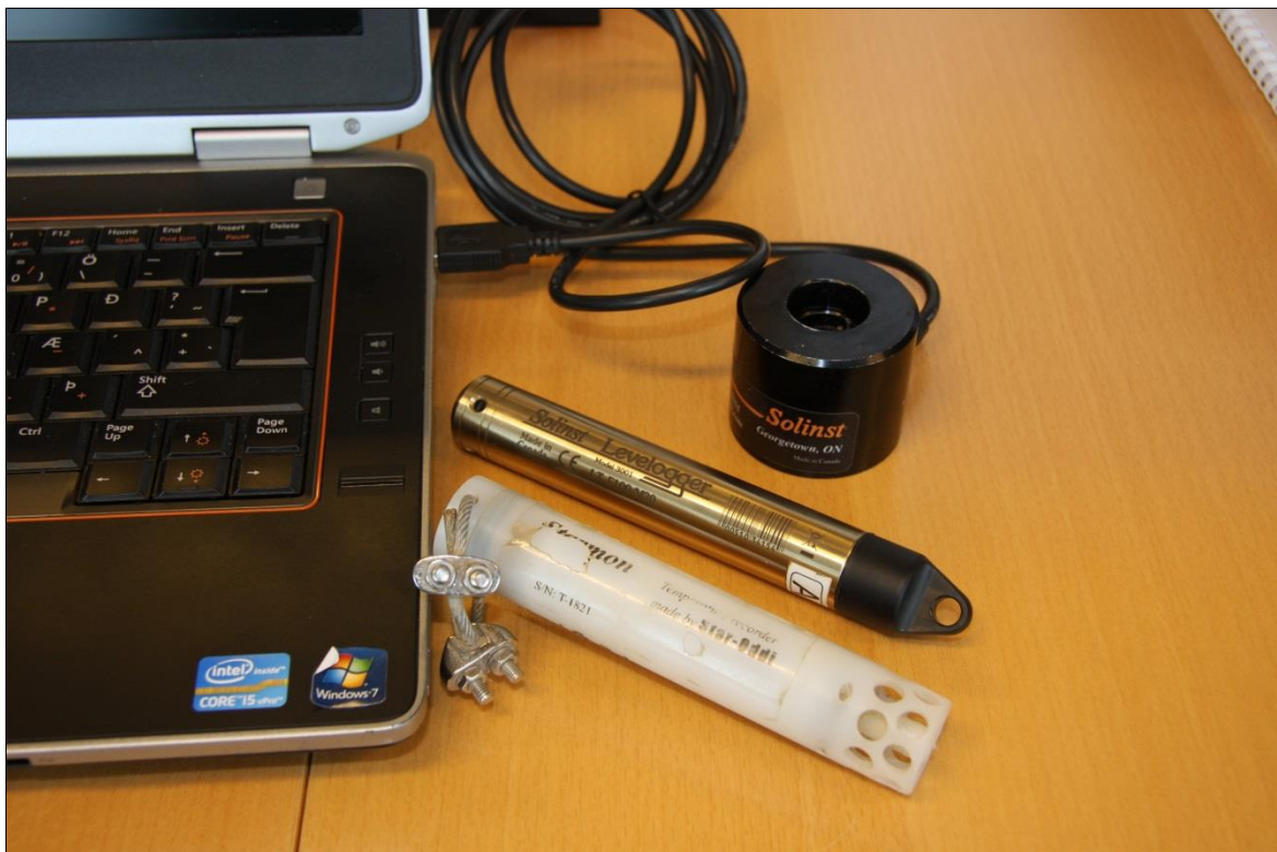
Mynd 1. Solinst þrýsti- og hitamælir (gylltur). Starmon hitamælir (plasthólkur).
