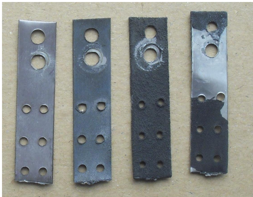
Mynd 5. Útfellingaplötur í varmaskipti eftir tilraun.
