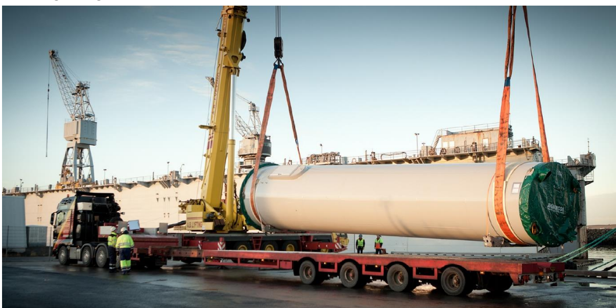
Mynd 7 Turn vindmyllunnar er stálrör sem mjókkar upp og er fest saman í þremur hlutum. Ljósmynd: Landsvirkjun.
