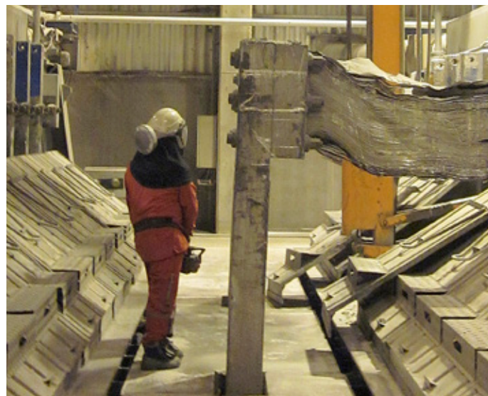
Kerskálastarfsmaður í skautskiptum með loftskiptahjál
