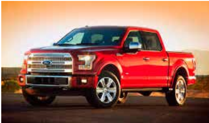
▲ Ford F-150: 95% yfirbyggingarinnar er úr áli. Það felur ekki einungis í sér eldsneytissparnað, heldur vinnur bifreiðin betur og hefur meiri dráttargetu fyrir vikið.
