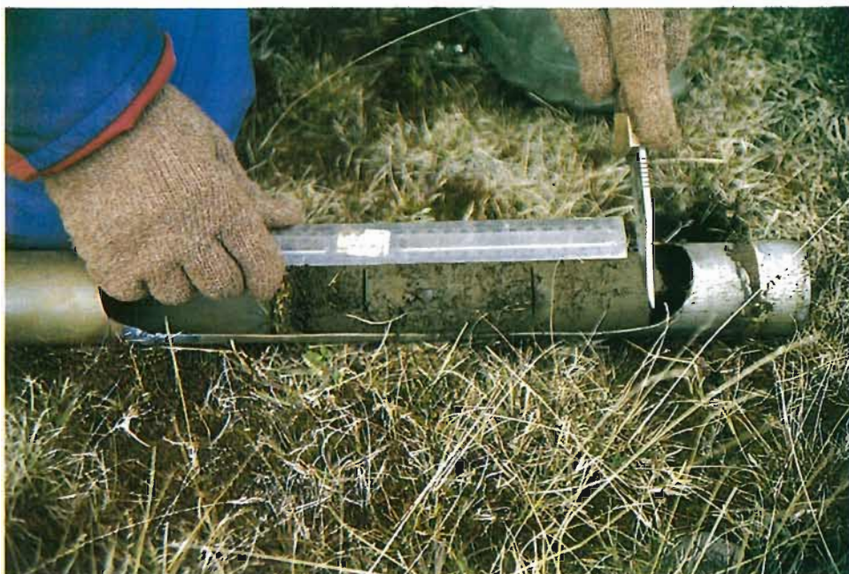
Rannsóknir á áhrifum beitara og umhverfispáttara á vöxt róta eru mikilvægar. Jarðvegsbor er notaður til að afla sýna til mælinga. Ljósmynd. Halldór Þorgeirsson.
