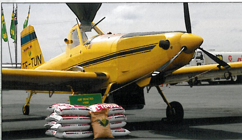
Air Tractor AT-400A TF-TUN III bar 1 tonn af áburði í ferð. Hér er áburðarmagnið sjúnt með áburðarpokum. Mynd: PPJ
