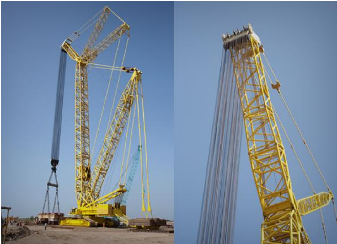
Mynd 8-5: 1600 tonna hreyfanlegur krani (Avezaa.2014).
