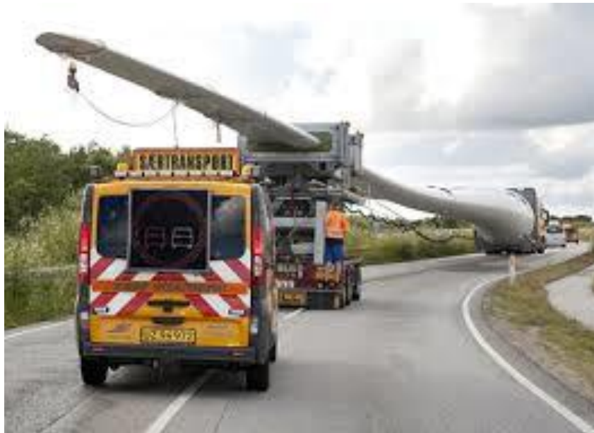
Mynd 8-6: Flutningur á blaði fyrir stærstu vindmyllu Siemens árið 2012 (þvermál snúningsflatar 154m (Siemens, 2012).
