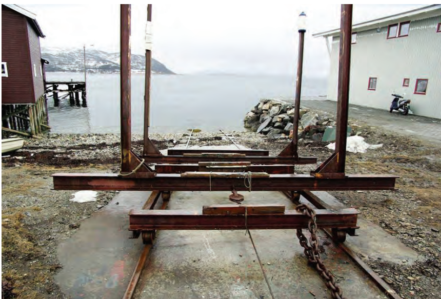
Figur 2. Oppdragsvogn på skinner, med flyttbare sidestøtter
