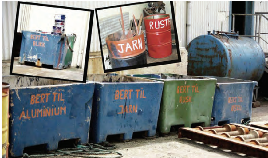
Figur 49. Containere for oppsamling av sortert metall, samt tank for oljeavfall
