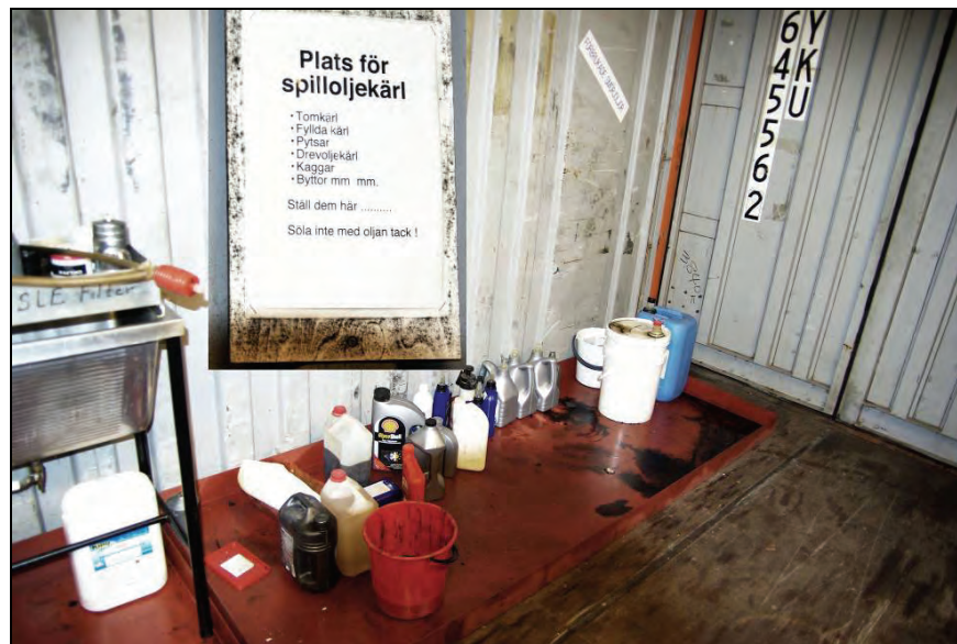
Figur 30. Oppsamlingskar for tomme og fylte kanner med oljeavfall på slipp Å 3.
