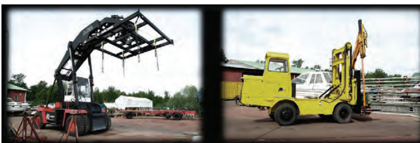
Figur 25. Truck for oppsett av båter og truck for service på master ved slipp Å 3.
