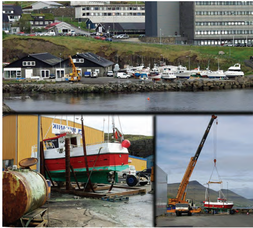
Mynd 38. Færanlegur krani lyftir báti upp á bryggju.
