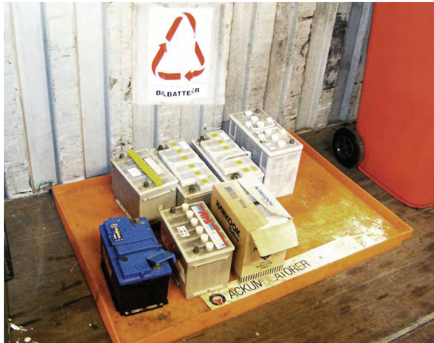
Mynd 28. Söfnunarbakki fyrir notaðar rafhlöður, slippstöð Á3.
