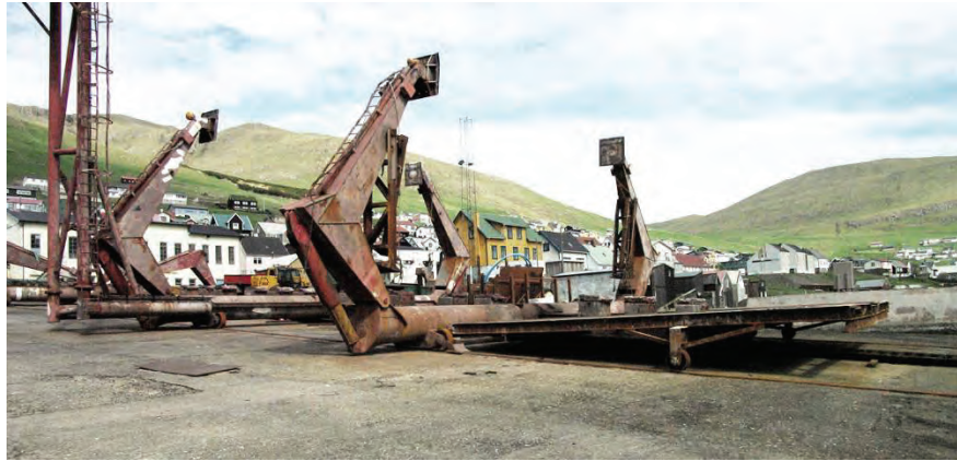
Mynd 45. Grind á teinum á heilsteyptu plani á slippstöð F3.
