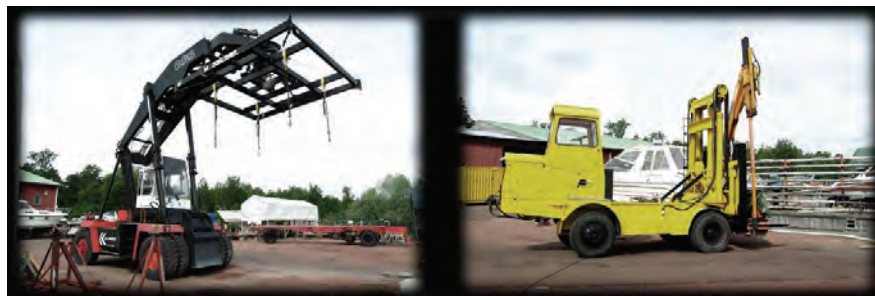
Mynd 25. Lyftari til að lyfta bátum í uppsátur og masturslyftari á slippstöð Á3.
