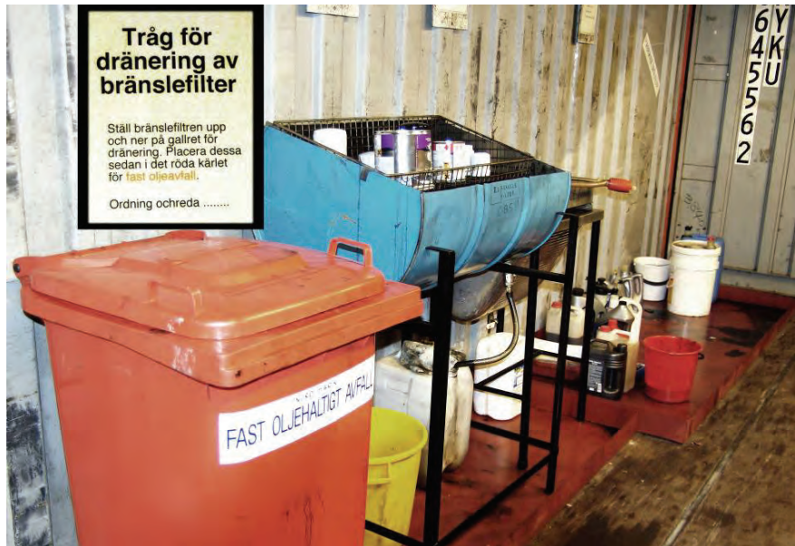
Mynd 29. Afrennslsker fyrir olíu á slippstöð Á3.
